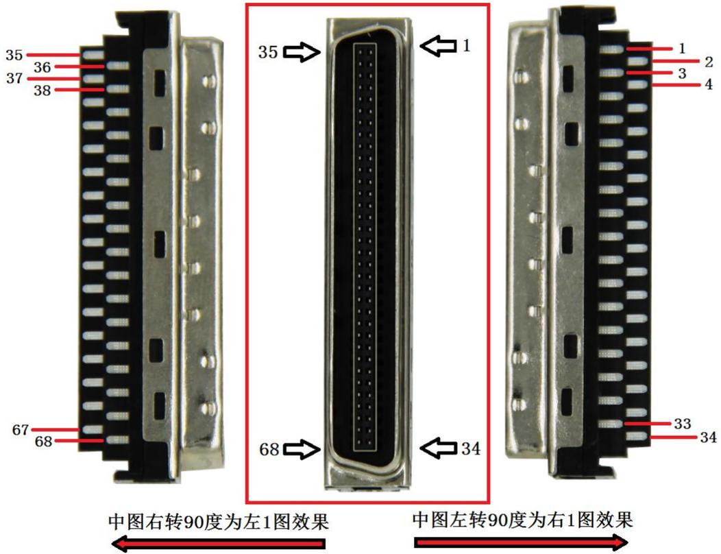
图 3-2 线缆焊接头标注
