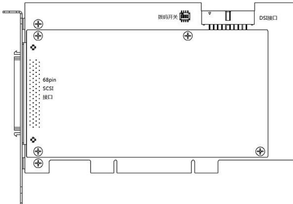
图 2-1 PCI-7863 产品布局图
